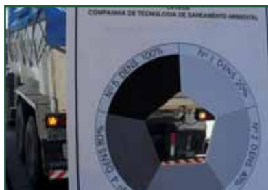
Monitoramento dos caminhões com Índice de Ringelmann.
