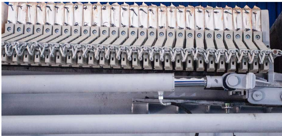
Filtro prensa localizado na unidade ITA3 em Mogi das Cruzes /SP.
